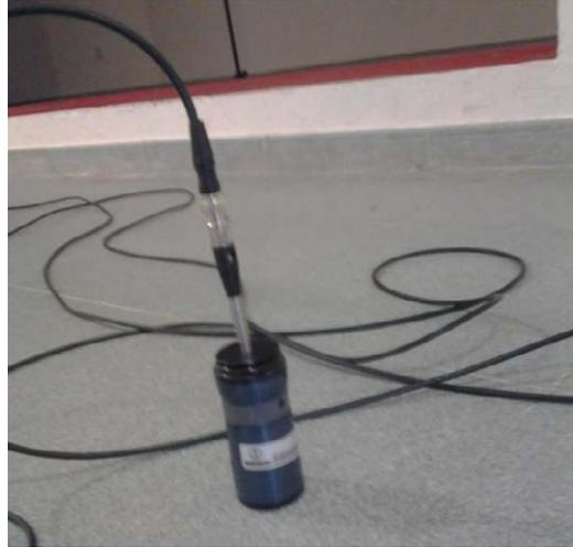
Figura 35. Calibración del micrófono de medida.
