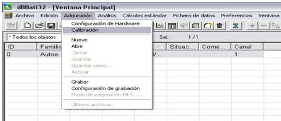
Figura 30. Menús de dBati y apertura de la opción Calibración.
