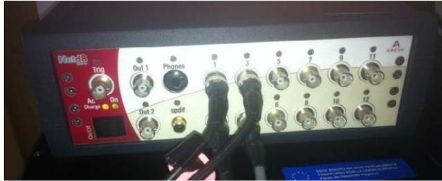
Figura 62. Conexión de canales de entrada de NetdB.
