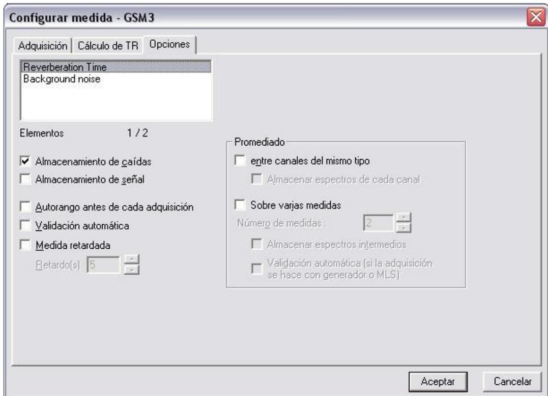
Figura 42. Pestaña Opciones de la configuración de la medida de Tiempo de reverberación.
