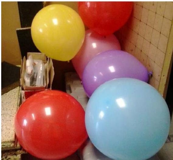
Figura 45. Globos preparados para la medición de Tiempo de reverberación.
