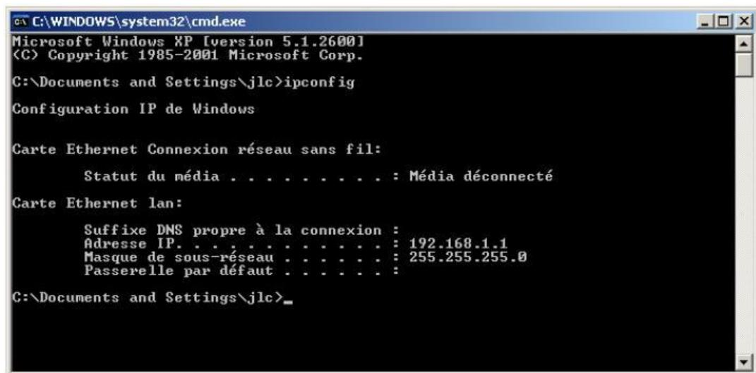
Figura 12. Comprobación de la correcta configuración de red.
