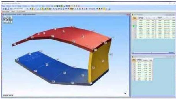
La misura avviene applicando una sollecitazione tramite martello strumentato o shaker oppure utilizzando le condizioni operative (senza quindi misurare l'ingresso di forza).
