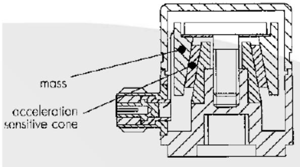
Gli accelerometri piezoelettrici sono disponibili con elettronica integrata (ICP, IEPE, CCP, sensibilità espressa in mV/g o in mV/m/s<sup>2</sup>) oppure senza elettronica integrata, con uscita quindi in "carica" (sensibilità espressa in mV/pC).
