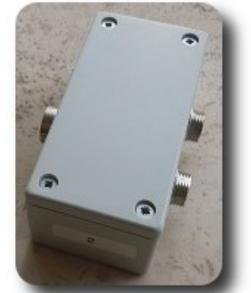
del campo di frequenze di campionamento e numero di canali che si intende utilizzare: da 20 m fino a 1.000 metri. Il cavo termina in una scatola con interfaccia via USB al PC ed alimentazione dalla presa di rete a 220 Vac.
