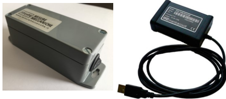
Centraline per misure di detensionamento.
