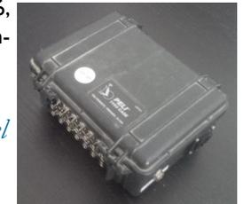
*Sistema di acquisizione per misura del tiro delle catene.*
