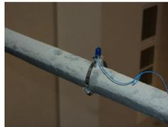
*Accelerometro per misura del tiro delle catene.*
