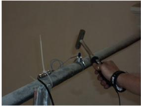
dinamica non invasiva (NDT), del tiro delle catene in opera. Il sistema è composto da uno (o più) accelerometri
